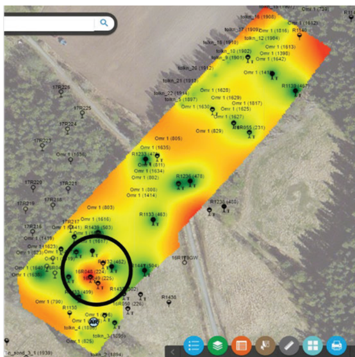
Figur 7. Det inringade området visar att trots ett förhållandevis stort antal sonderingspunkter är osäkerheten i bedömning av bergnivån stor (rött).
