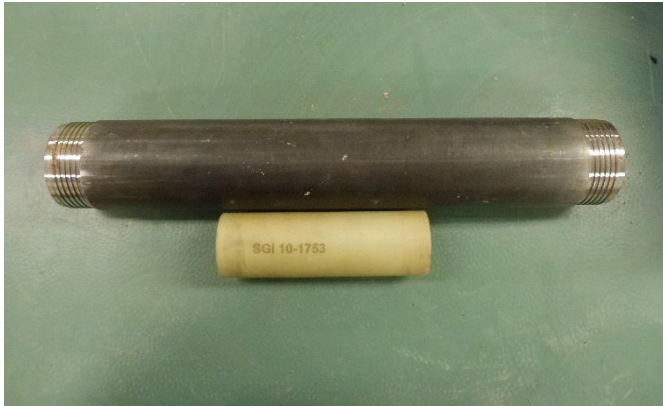
Figur 5. Rörprovtagare typ Shelby (överst) och kolvprovtagningshylsa (underst) (Lundström et al., 2019).
