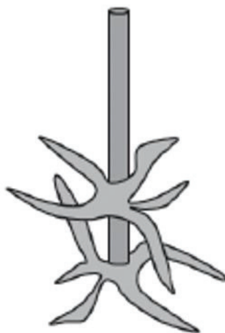
Figur 1. Injekteringsens spridning i jorden.
