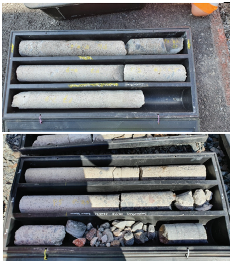
Figur 11. Exempel på upptagna kärnbörpröver.
