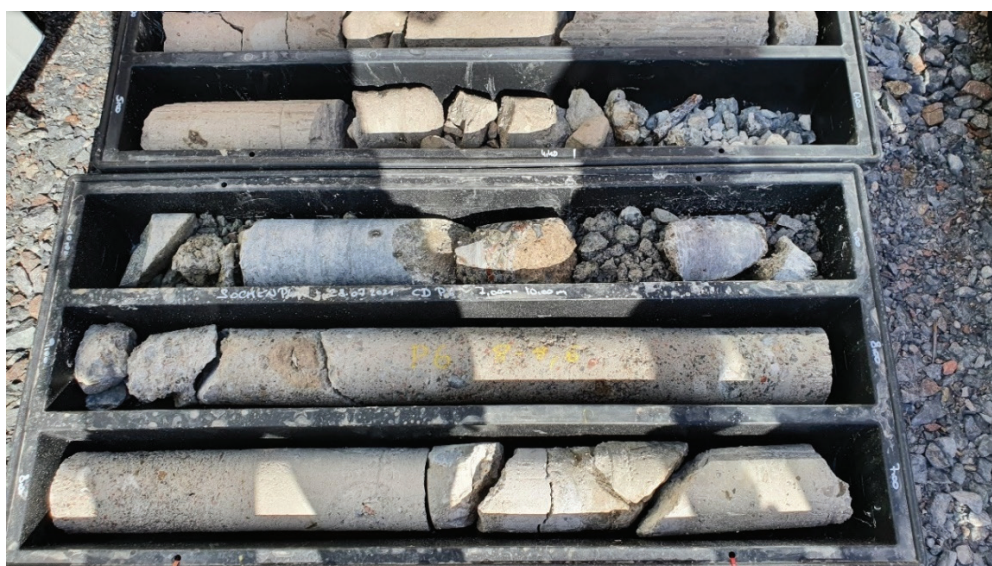
Figur 12. Beroende på jordens sammansättning erhålls olika kvalitet på kärnbörpröver.
