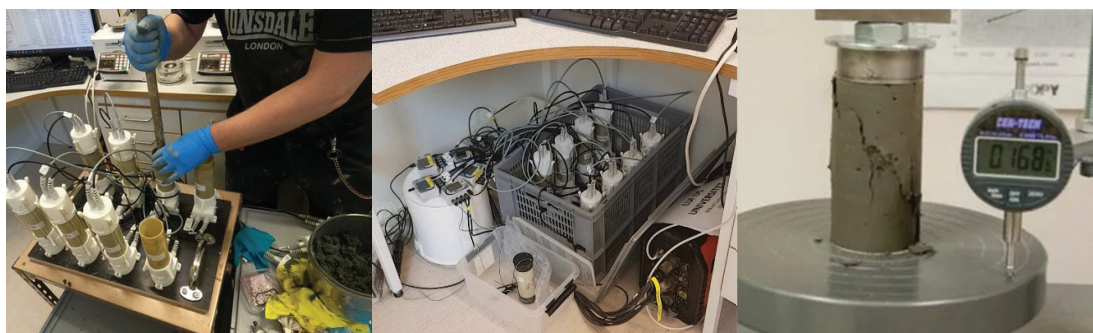
Figur 5. Laborieförsök med KC-inblandning i SGIs laboratorium.
