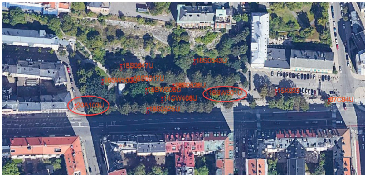
Figur 42 Skiss som redovisar omfattning av grundvattenrör. Grundvattenrören 20A103U och 16SW501U (röda ringar) har instrumenterats av Implenia med tryckgivare för automatisk mätning.
