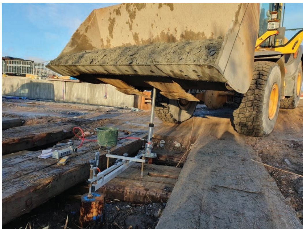
Figur 10. Uppställning av provningsutrustning samt mothållsvikt från jordfylld traktorskopa.
