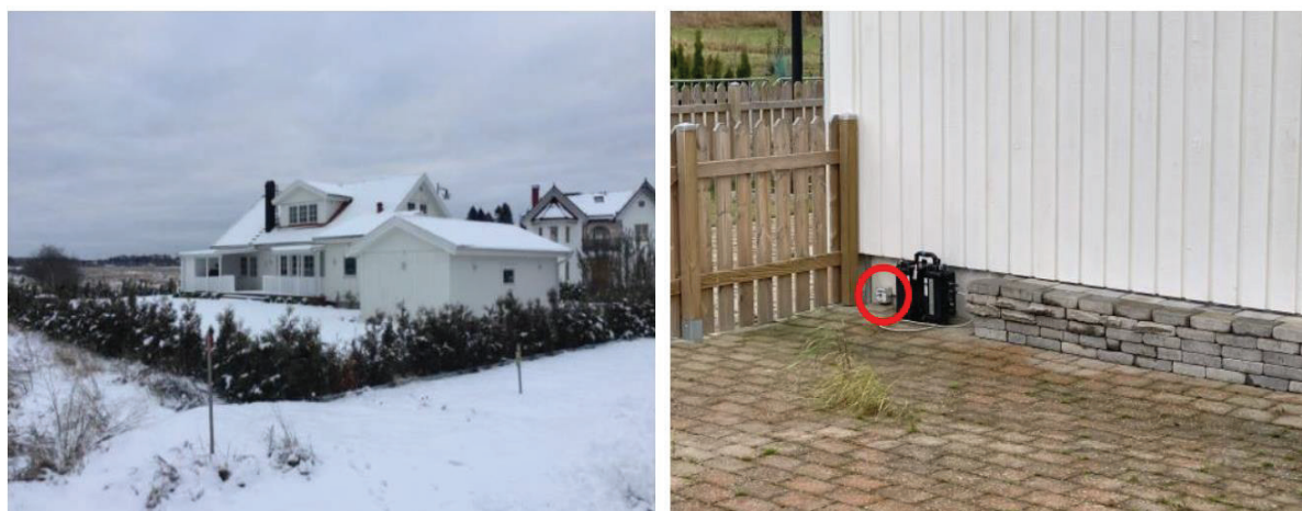
Bild 9. Vibrationsmätare (vertikal geofon) installerad av huskant.
